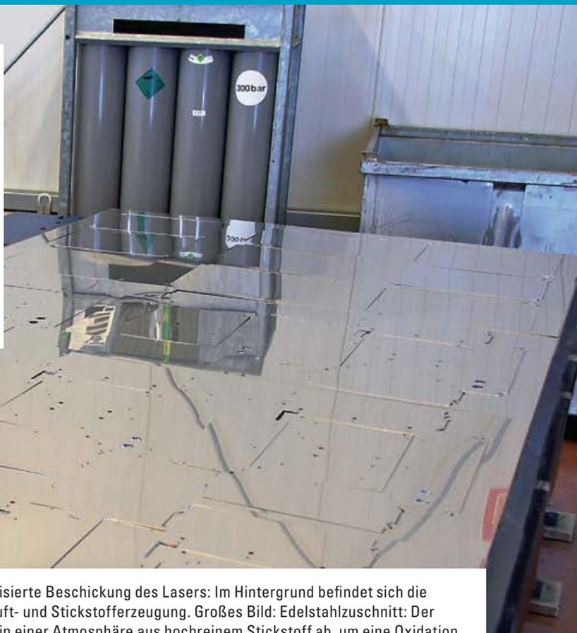
Kleines Bild: Automatisierte Beschickung des Lasers: Im Hintergrund befindet sich die Bühne mit der Druckluft- und Stickstoffherzeugung. Großes Bild: Edelstahlzuschnitt: Der Schneidprozess läuft in einer Atmosphäre aus hochreinem Stickstoff ab, um eine Oxidation an den Schnittkanten auszuschließen.
